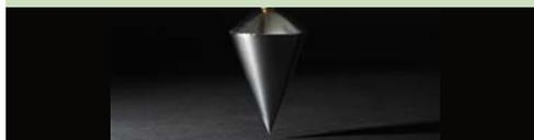
El plomo se utiliza para fabricar caños, tuberías y elementos de pesca, como plomadas. El plomo, por efecto de la corrosión u oxidación, contamina el agua y le otorga un sabor ácido.
