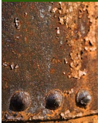
Los caños o materiales metálicos expuestos al oxígeno atmosférico se oxidan progresivamente deteriorando su superficie por la formación de óxidos.
