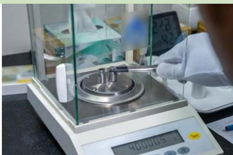
Balanza electrónica de laboratorio.
