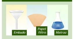
Filtración: esta técnica es utilizada para separar las partículas sólidas de un líquido, como por ejemplo la arcilla y el agua. Para ello se utiliza un material poroso permeable al líquido contenido en la mezcla, el cual actúa como una barrera selectiva que retiene las partículas sólidas cuando se hace pasar la mezcla a través de ella.
