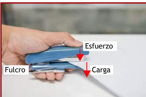
La longitud del brazo de carga va hasta el punto de apoyo y siempre es mayor que la longitud del brazo de esfuerzo.
