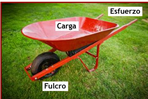
La longitud del brazo de esfuerzo llega hasta el fulcro y siempre es mayor que la longitud del brazo de carga en una palanca de clase 2.
