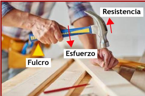
La longitud del brazo de esfuerzo puede ser mayor, igual o menor que la longitud del brazo de carga en una palanca de clase 1.
