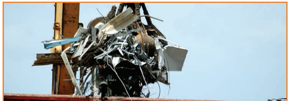
Muchas de las grúas que utilizan en las industrias disponen de un electroimán muy poderoso para poder mover toneladas de metal.
