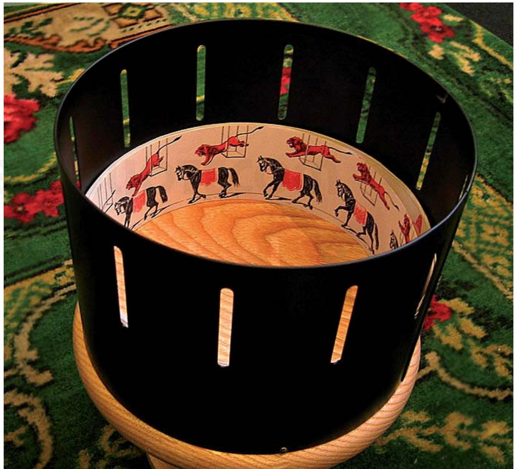
Fotografía de la máquina estroboscópica Zoótropo.
