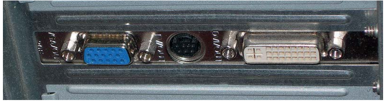
Salidas SVGA, S-Video y DVI de una tarjeta gráfica
