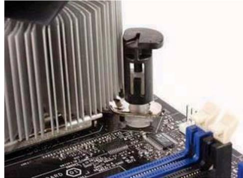
Una vez montado el cooler pasamos a conectar el ventilador a la placa. El conector es normalmente de color y siempre está muy cerca el cooler y que consta de 3 pines, esto le brinda energía al ventilador para que funcione. Así por fin tenemos instalado el procesador.
