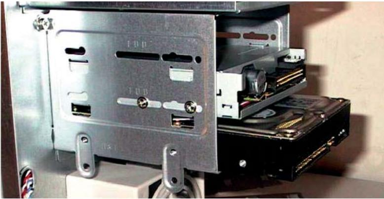
Antes de conectarlo debemos saber si vamos a utilizar más de un disco rígido, ya que si es así, debemos hacer una pequeña configuración en los jumpers ubicados en la parte posterior del mismo.
